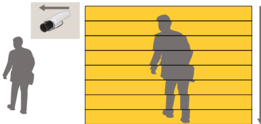
Figure 2. 卷帘快门失真的原理。传感器从图像的上方至下方读取行。如果在正读取行时，振动导致摄像机稍微左移，则会得到畸变的图像。
