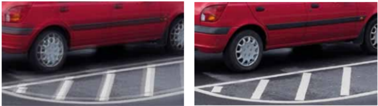
图 4.1 模拟图像。左：未启用电子图像稳定时的近景照，同时存在水平和垂直运动模糊。右：启用了电子图像稳定时振动摄像机的抓拍照。
