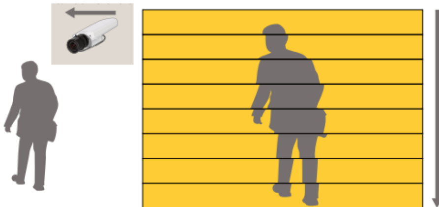
图 5.1 卷帘快门失真的原理。传感器从图像的上方至下方读取行。如果在正读取行时，振动导致摄像机稍微左移，则会得到畸变的图像。
