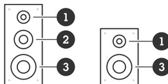
Figure 9. Haut-parleurs hi-fi. Pilote d'aigus (1), pilote de médiums (2) et pilote de graves (3).
