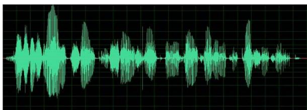
Figure 5. Visualisation d'un enregistrement à large plage dynamique, sans compression.
