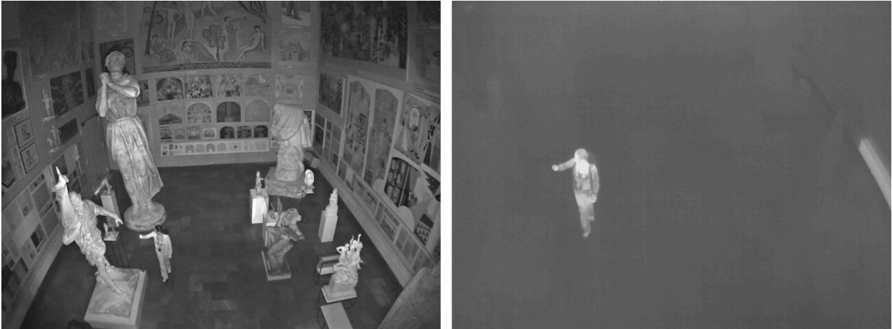
Bilder zum Vergleich von einer Tag-und-Nacht-Kamera und einer Wärmebildkamera, die beide bei Dunkelheit aufgenommen wurden.
