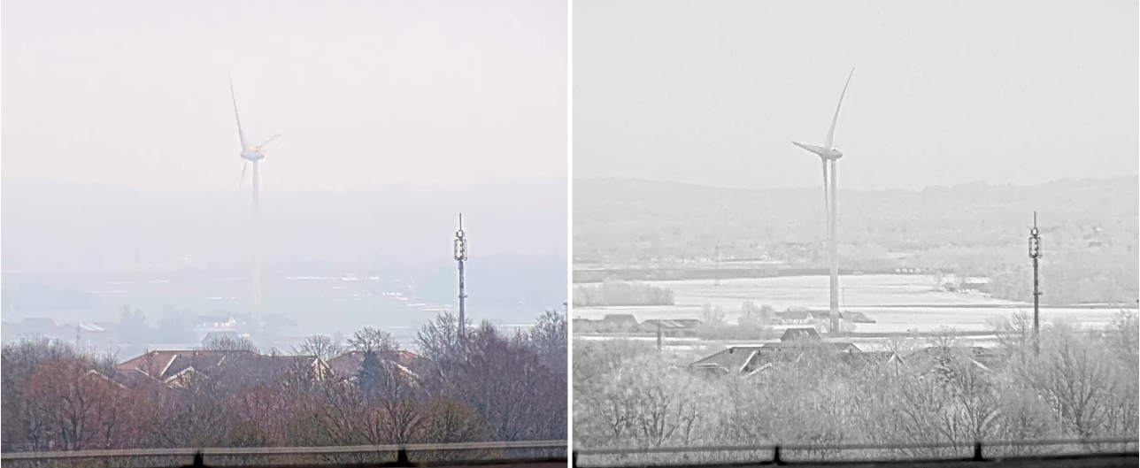
Fernschnappschüsse im Tag-Modus (links) und mit dem IR-Durchlassfilter (rechts). Der IR-Durchlassfilter verbessert den Kontrast und die Sichtbarkeit der Windkraftanlage (in 10 km (~6 Meilen) Entfernung) sowie der Hügel im Hintergrund (in 20 km (~12 Meilen) Entfernung), und die Vegetation auf den Feldern erscheint heller. Aufgenommen mit einer AXIS Q6355-LE PTZ Camera.
