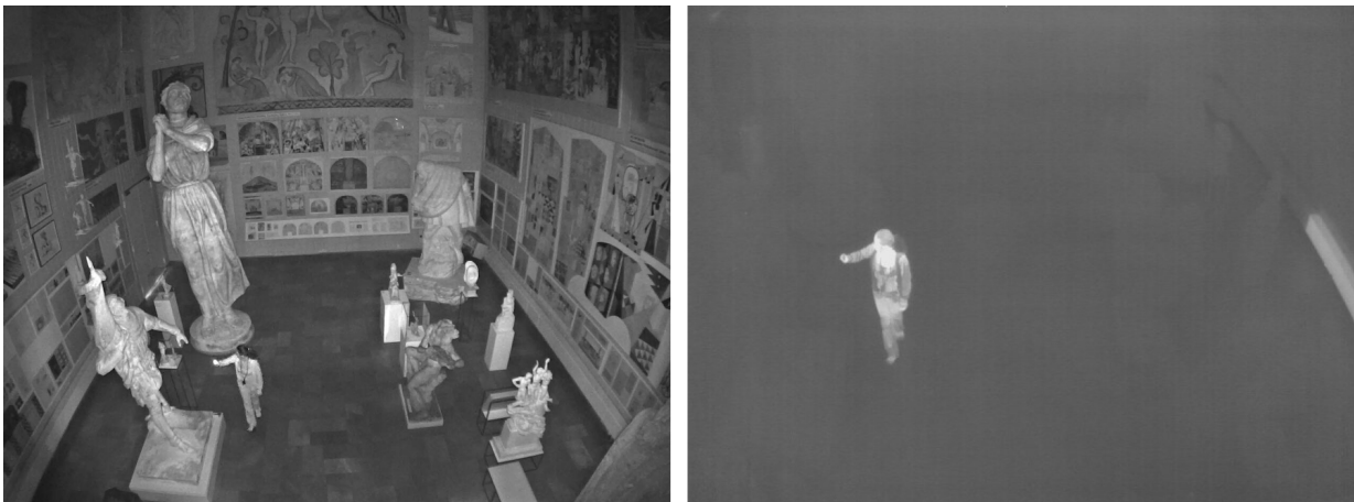
Figure 4. Imágenes comparativas de una cámara con funcionalidad día/noche y una cámara térmica, las dos capturadas en la oscuridad.
