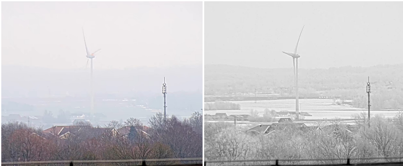
Instantáneas de largo alcance en modo diurno (izquierda) y con el filtro de paso de infrarrojos (derecha). El filtro de paso de infrarrojos mejora el contraste y la visibilidad del aerogenerador (10 km (~6 millas)) y las colinas del fondo (20 km (~12 millas)), y la vegetación de los campos aparece más brillante. Grabado con AXIS Q6355-LE PTZ Camera.
