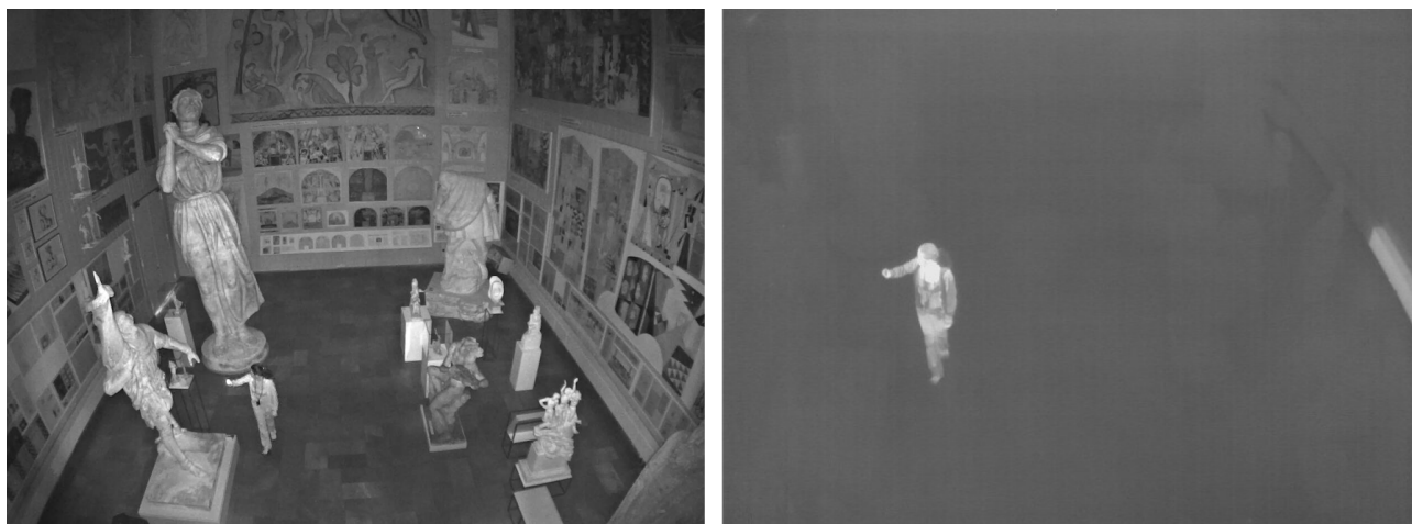
Imágenes comparativas de una cámara con funcionalidad día/noche y una cámara térmica, las dos capturadas en la oscuridad.
