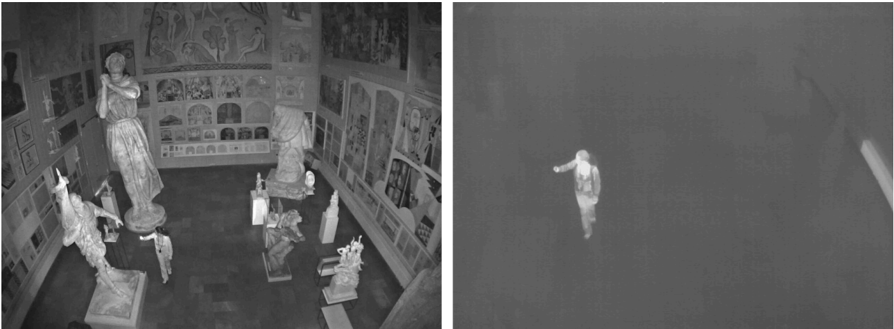
Images comparant la caméra jour/nuit et la caméra thermique, toutes deux capturées dans l'obscurité.
