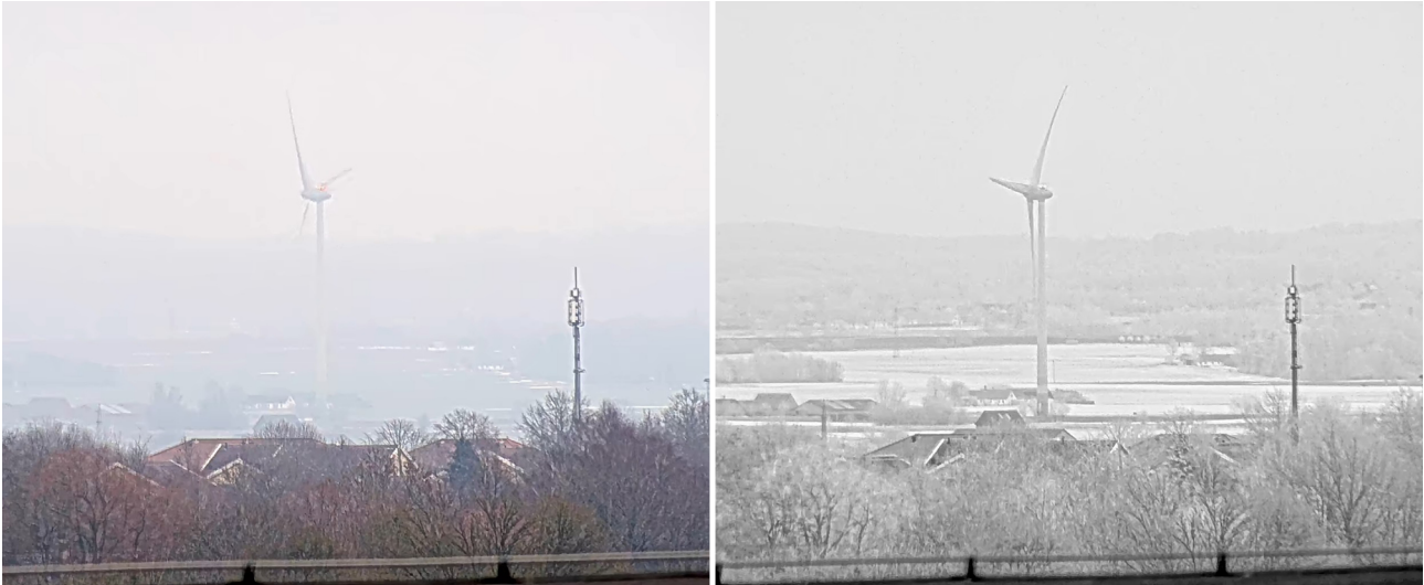
Istantanee a lunga distanza in modalità giorno (a sinistra) e con il filtro IR-pass (a destra). Il filtro IR-pass migliora il contrasto e la visibilità della turbina eolica (10 km (~6 miglia) di distanza) e delle colline sullo sfondo (20 km (~12 miglia) di distanza), mentre la vegetazione nei campi appare più luminosa. Riprese effettuate con AXIS Q6355-LE PTZ Camera.
