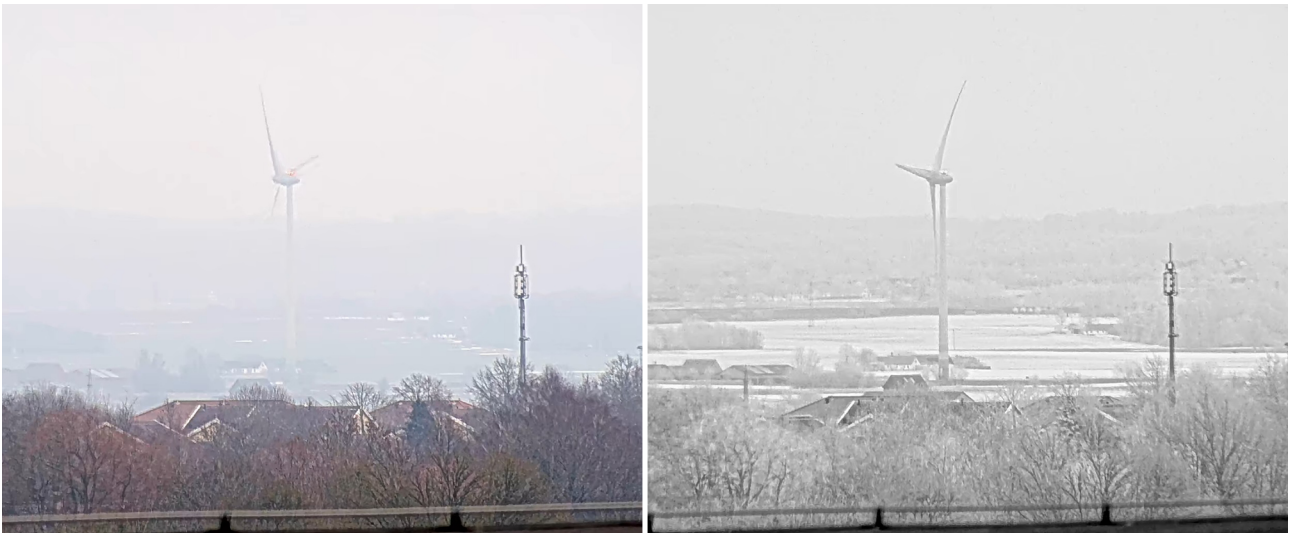
長距離撮影の比較 (左) デイモード、(右) IRパスフィルター使用時IRパスフィルターは、(10 km (約6マイル)) 離れた風力発電タービンや(20 km (約12マイル))離れた背景の丘陵のコントラストと可視性を高め、さらに畑の植生もより明るく映し出します。AXIS Q6355-LEPTZカメラで撮影。
