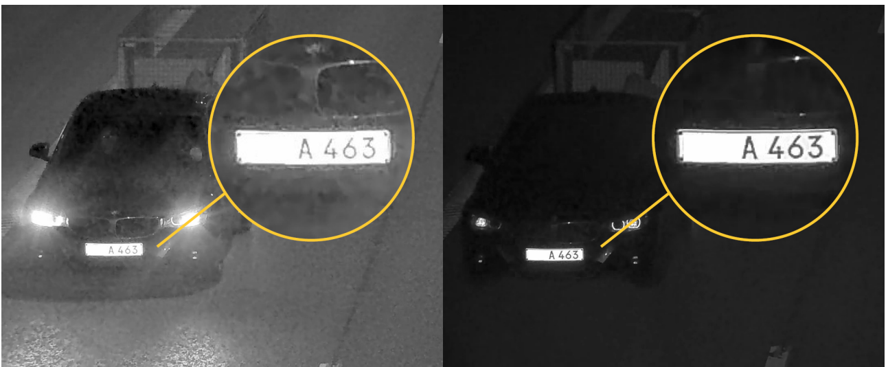
ナイトモードでのスナップショット (左) とIRパスフィルター使用時のスナップショット (右)。両方のスナップショットは、AXIS Q6355-LE PTZカメラで撮影され、距離 50 m (55 yd)、光学ズーム7倍の条件下で撮影されています。
