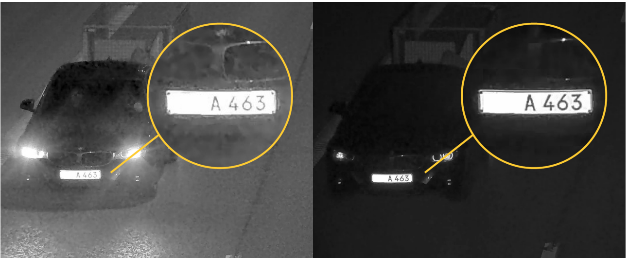
야간 모드(왼쪽)와 IR 투과 필터 적용(오른쪽) 상태로 촬영한 스냅샷. 두 장의 스냅샷 모두 AXIS Q6355-LE PTZ Camera를 사용하여 50m(55야드) 거리에서 7배 광학 줌을 적용해 촬영한 것입니다.
