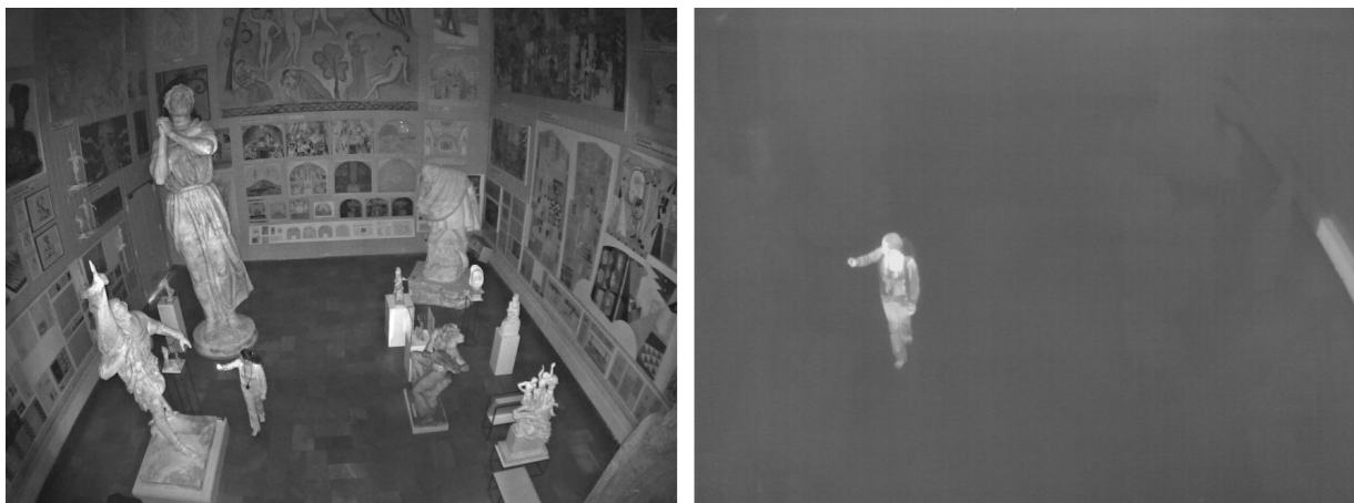
Figure 4. Porównanie obrazów z kamery z trybem pracy dzień/noc i kamery termowizyjnej – oba zarejestrowano w ciemności.
