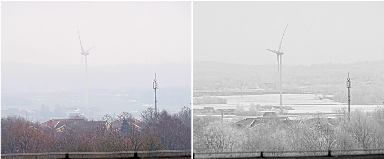
Ujęcia z dużej odległości w trybie dziennym (z lewej) oraz z filtrem pasmowo-przepustowym podczerwieni (z prawej). Filtr pasmowo-przepustowy podczerwieni poprawia kontrast i widoczność turbiny wiatrowej (znajdującej się w odległości 10 km (ok. 6 mil)) oraz wzgórz w tle (znajdujących się w odległości 20 km (ok. 12 mil)), natomiast roślinność na polach wydaje się jaśniejsza. Nagranie wykonano kamerą PTZ AXIS Q6355-LE PTZ Camera.
