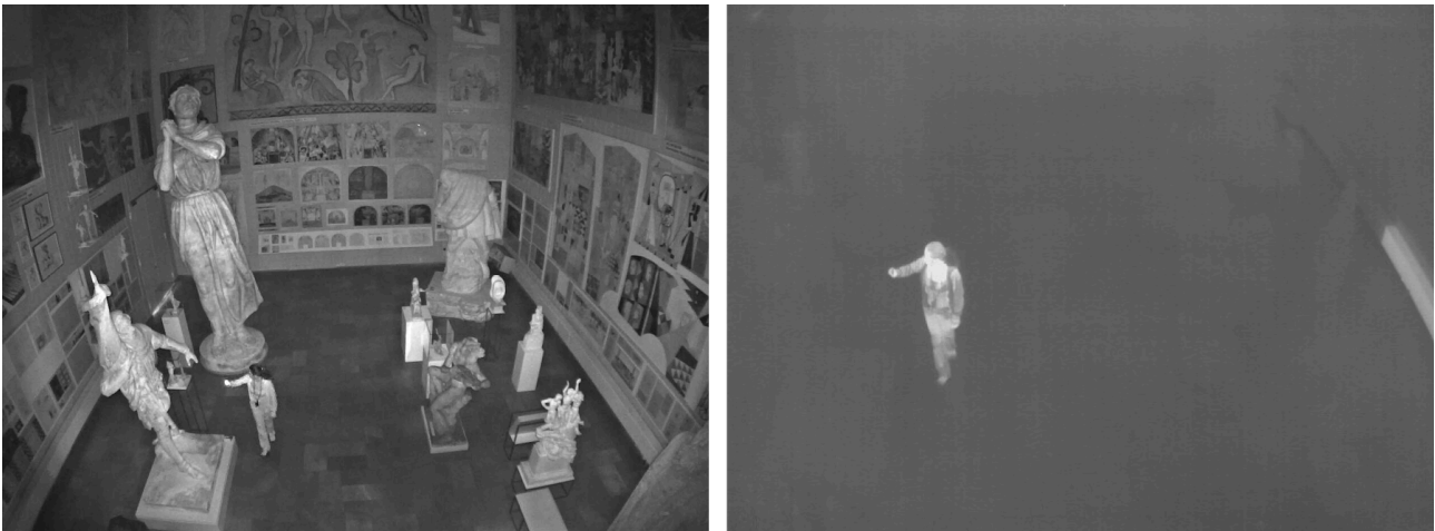
Porównanie obrazów z kamery z trybem pracy dzień/noc i kamery termowizyjnej – oba zarejestrowano w ciemności.
