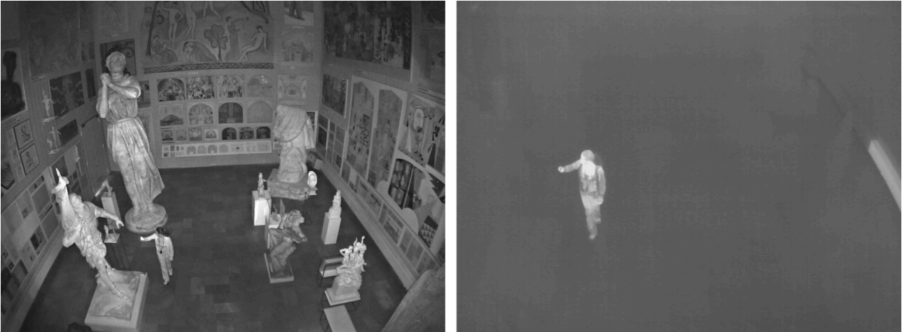
Imagens comparando a câmera dia e noite e a câmera térmica, ambas capturadas no escuro.
