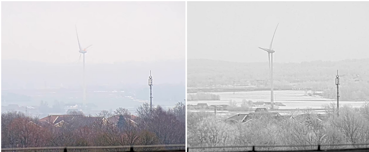
Instantâneos de longo alcance no modo diurno (à esquerda) e com o filtro de passagem de IR (à direita). O filtro de passagem de IR realça o contraste e a visibilidade da turbina eólica (a 10 km [~6 milhas] de distância) e das colinas ao fundo (a 20 km [~12 milhas] de distância), e a vegetação nos campos parece mais clara. Filmado com a AXIS Q6355-LE PTZ Camera.
