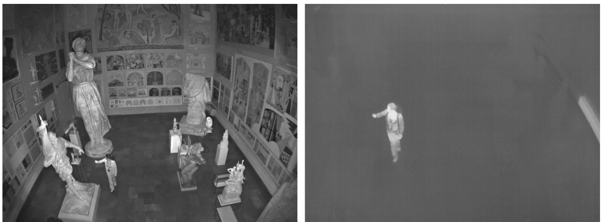
Figure 4. 日夜型摄像机和热成像摄像机的图像比较（均拍摄于黑暗环境）。
