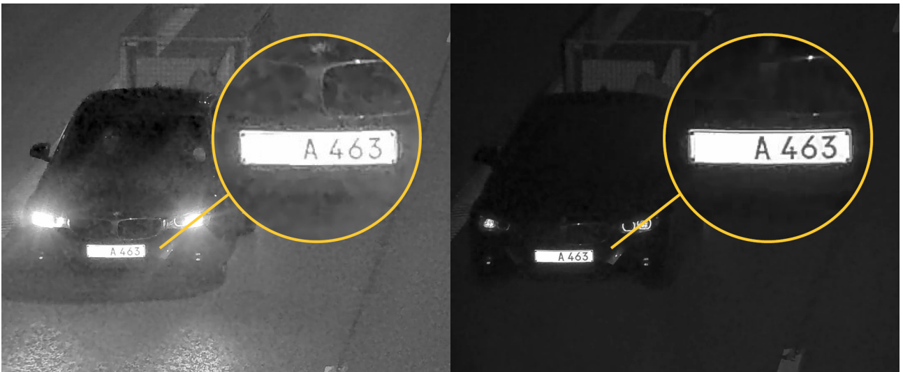
夜间模式下的抓拍（左）和使用红外通滤光片的抓拍（右）。这两张抓拍均由AXIS Q6355-LE PTZ Camera拍摄，拍摄距离为50米（55码），使用7倍光学变焦。
