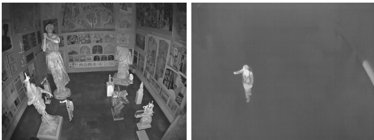
日夜型摄像机和热成像摄像机的图像比较（均拍摄于黑暗环境）。
