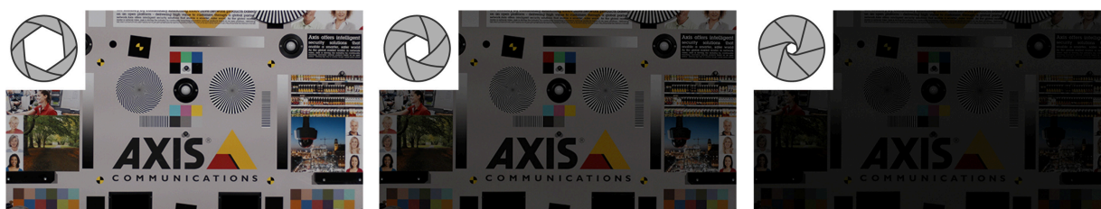
La capacité de collecte de lumière d'une caméra est plus élevée lorsque la valeur f est plus faible.
