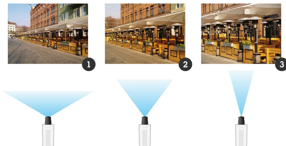
Champ de vision avec objectif grand angle (1), objectif de vue normale (2) et téléobjectif (3).
