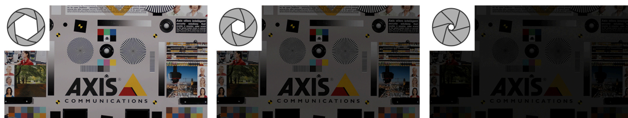
カメラの集光能力は、F値が小さいほど高くなります。
