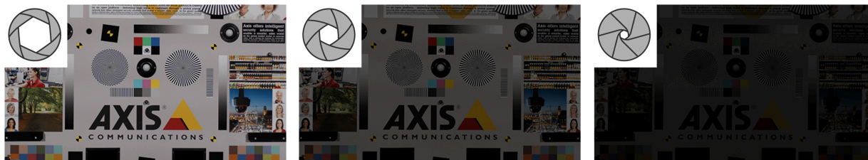
Zdolność zbierania światła przez kamerę jest tym większa, im wartość f jest niższa.
