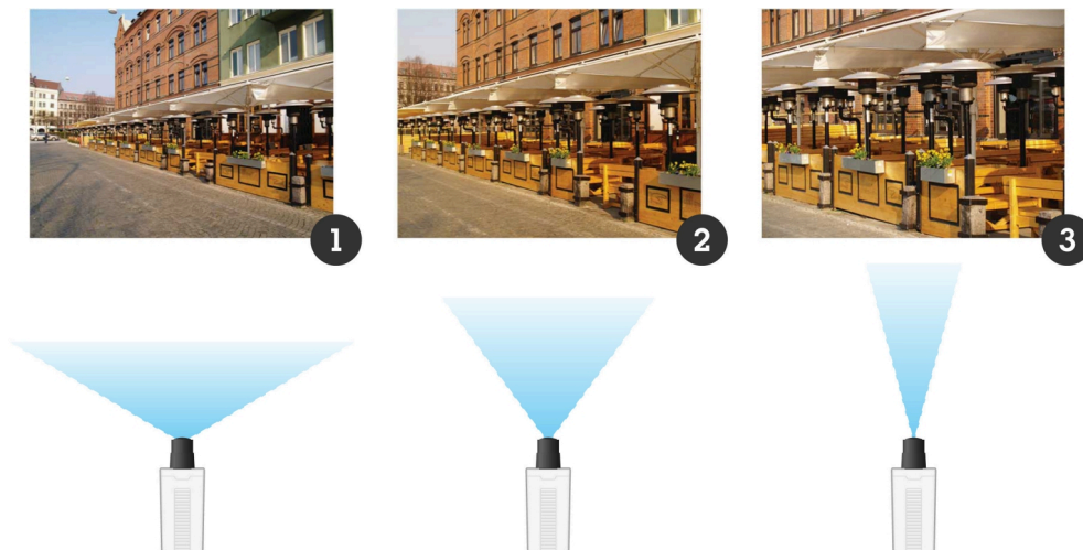
Pole widzenia z obiektywem szerokokątnym (1), obiektywem normalnym (2) i teleobiektywem (3).
