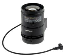
Uma lente C/CS possui um rosqueamento de montagem específico, o que facilita a troca. Esse tipo de lente é usado em câmeras box. Essas lentes estão disponíveis em diversas distâncias varifocais e com controle DC ou P-Iris. Elas oferecem excelente flexibilidade e são adequadas para várias aplicações de monitoramento.
