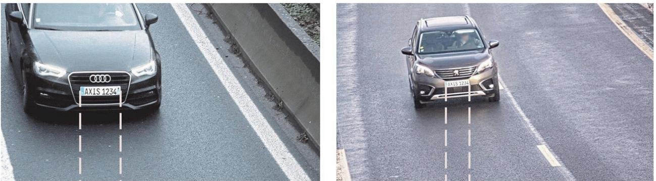
Die Anzahl der erforderlichen Pixel für die Kennzeichenbreite hängt von Kameraauflösung und Szenenbreite ab. Diese Beispielbilder wurden mit einer Kamera mit einer Auflösung von 1080x1920 Pixeln aufgenommen.
