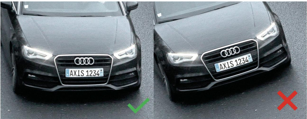
*Richten Sie die Kamera so aus, dass das Kennzeichen parallel zur Bildkante ist.*
