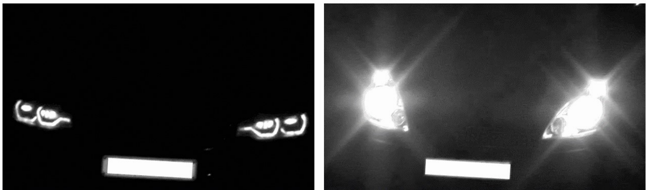
Deux images prises presque simultanément, avec des réglages et un alignement identiques, et en utilisant une caméra équipée d'un filtre passe-IR.
