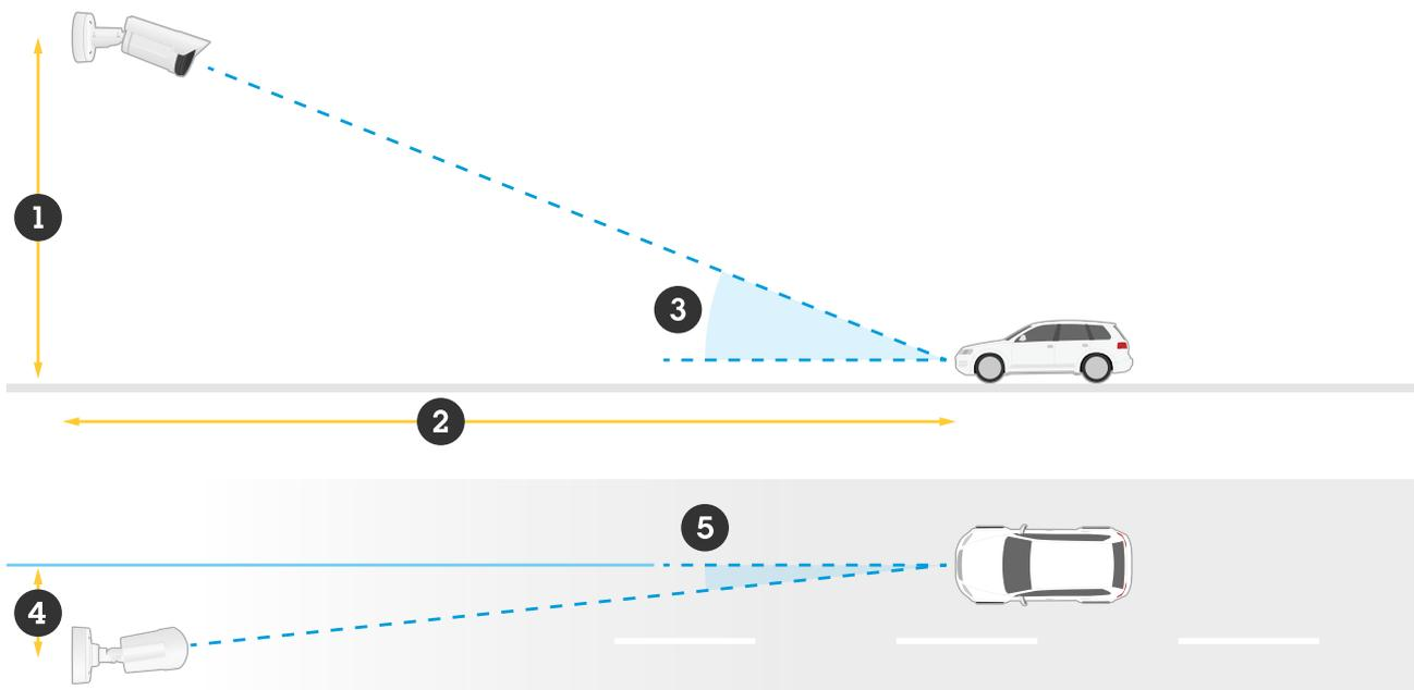
*L'altezza di montaggio (1) e la distanza di rilevamento (2) determinano l'angolo verticale (3) tra la telecamera e la direzione di marcia dell'auto. La distanza dal centro della strada (4) determina l'angolo orizzontale (5) tra la telecamera e la direzione di marcia dell'auto*
