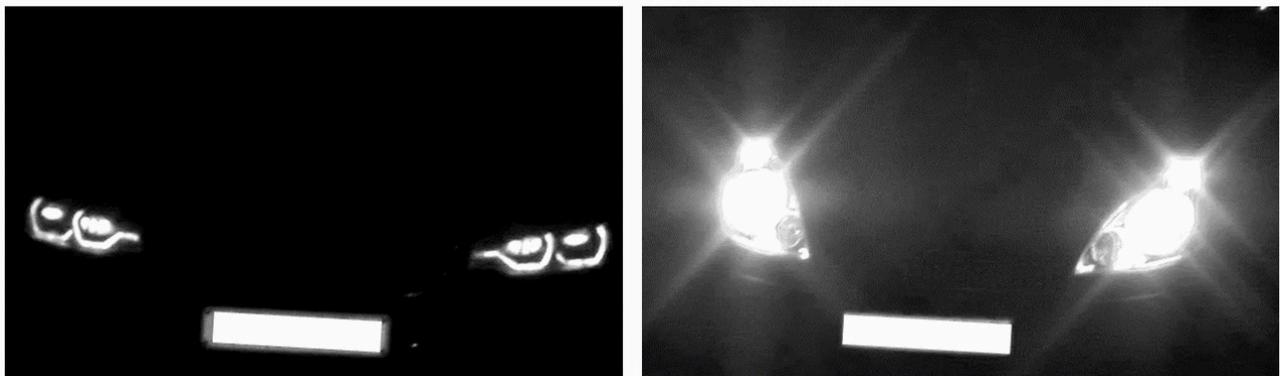
*Due immagini scattate simultaneamente, con impostazioni e allineamento identici, usando una telecamera dotata di filtro per il passaggio degli IR.*
