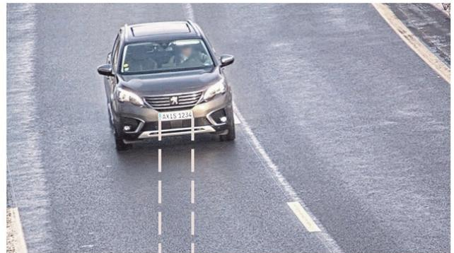
ナンバープレートの幅全体のピクセル数は、カメラの解像度と撮影シーンの幅によって異なります。これらの例は、解像度1080x1920ピクセルのカメラで撮影されています。
