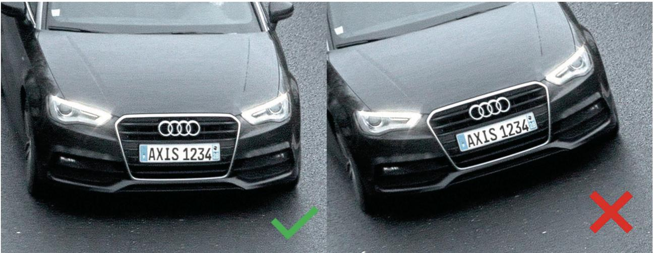
ナンバープレートが画像の端と平行になるように、カメラの位置を調整します。
