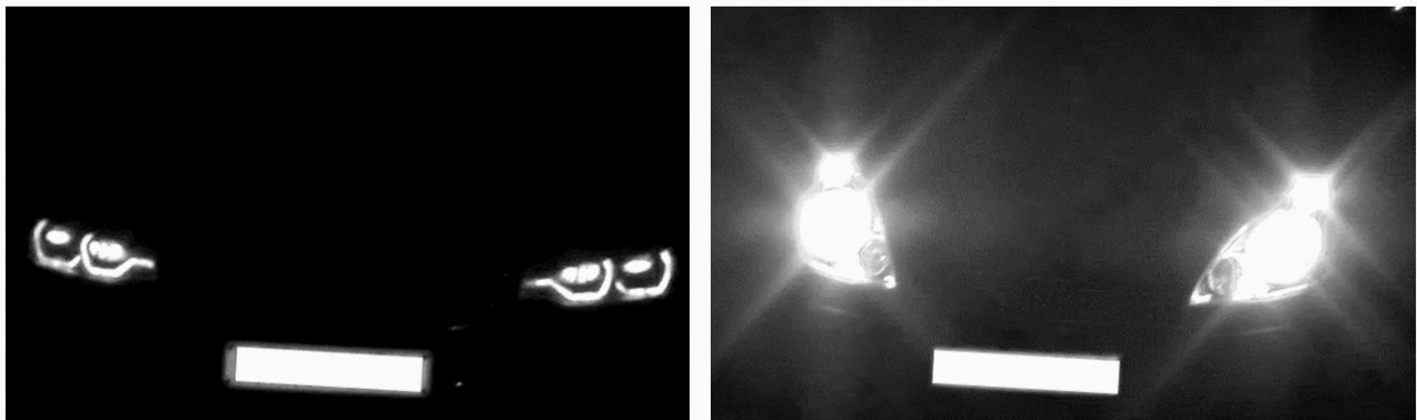
Duas imagens tiradas quase simultaneamente, com ajustes e alinhamento idênticos, usando uma câmera equipada com filtro de passagem de IR.
