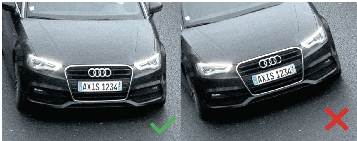
Figure 10. Камеру необходимо расположить так, чтобы изображение номерного знака было параллельно краю кадра.
