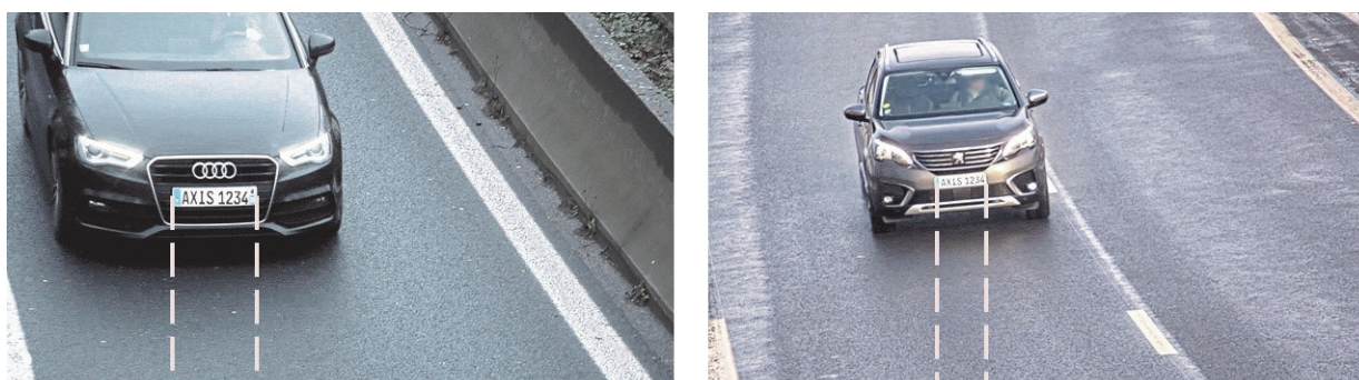
Figure 6. Количество пикселей на ширине номерного знака зависит от разрешения камеры и ширины области обзора. В этом примере камера с разрешением 1080x1920 пикселей наводится (слева) на одну полосу (ширина 4 м) или (справа) на ширину почти двух полос (ширина 6,5 м). Номерной знак занимает соответственно 250 пикселей и 154 пикселя.
