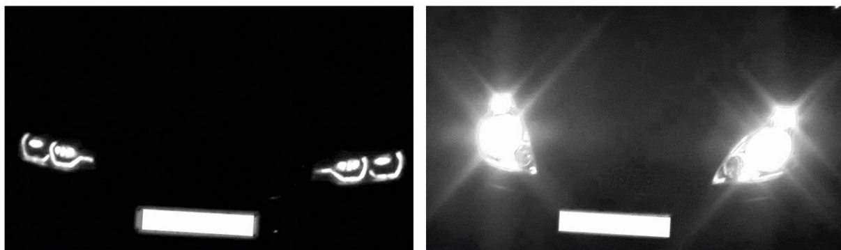
Figure 16. Слева: ИК фильтр задерживает свет светодиодных фар, эффективно снижая засветку и паразитные отражения в объективе. Справа: свет галогенных фар проходит через ИК фильтр, образуя засветку в объективе. Эти два изображения были сняты почти одновременно, с одинаковыми настройками и ориентацией камеры, одной и той же камерой с ИК фильтром.
