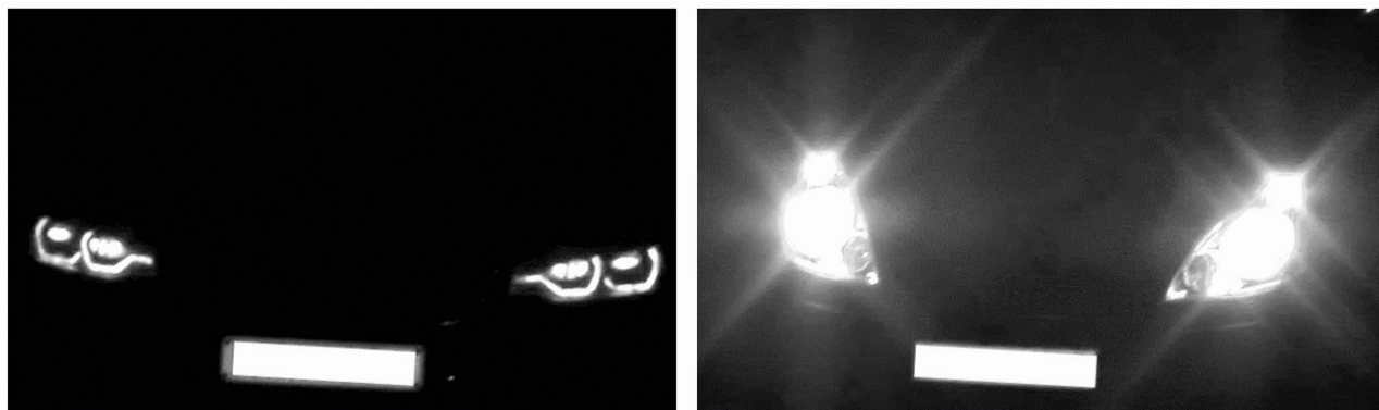
几乎同时拍摄的两个图像，所用的设置和对准都相同，并且均采用了配有红外带通滤光片的摄像机。
