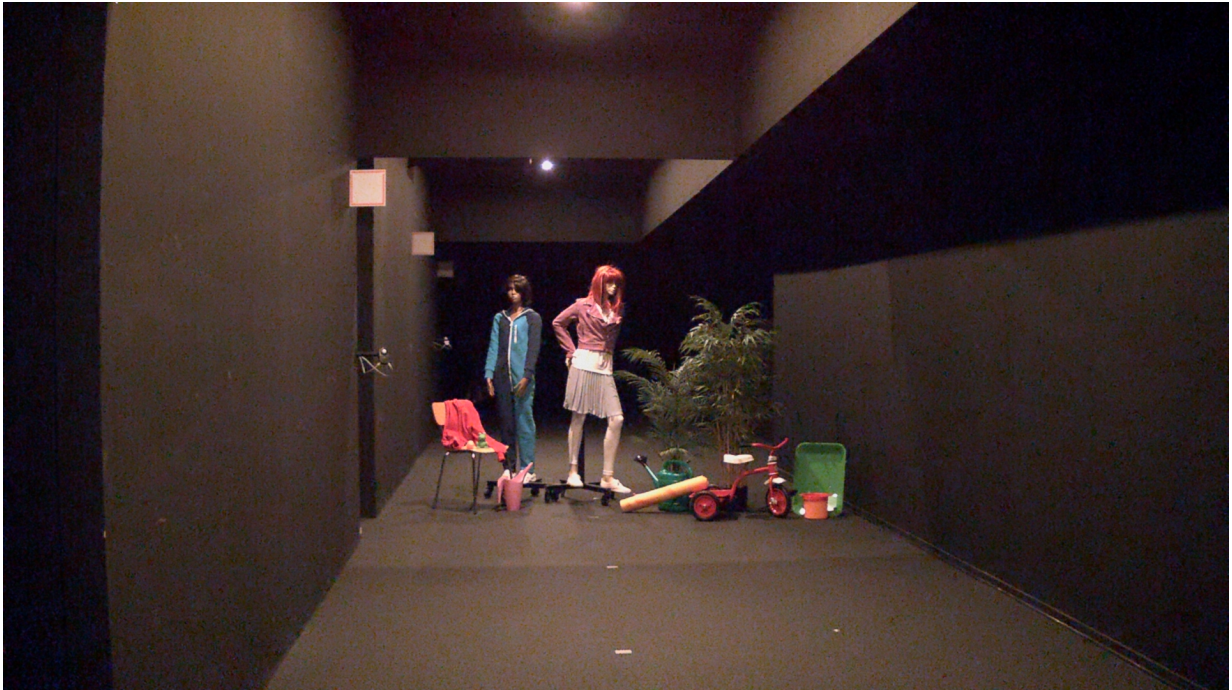
Figure 5. 0,2 Lux – 0,7 Lux an den Objekten gemessen. Die Kamera mit Lightfinder liefert kräftige Farben. Das menschliche Auge konnte kaum Farben erkennen. Es konnte vor allem helle Flächen mit sehr wenigen Details erkennen.
