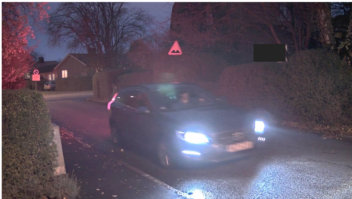
Figure 8. Lange Belichtungszeit kann sichtbare Bewegungsunschärfe hervorrufen. Bei diesem Schnappschuss wäre das Kennzeichenschild bei einer kürzeren Belichtungszeit möglicherweise lesbar gewesen.
