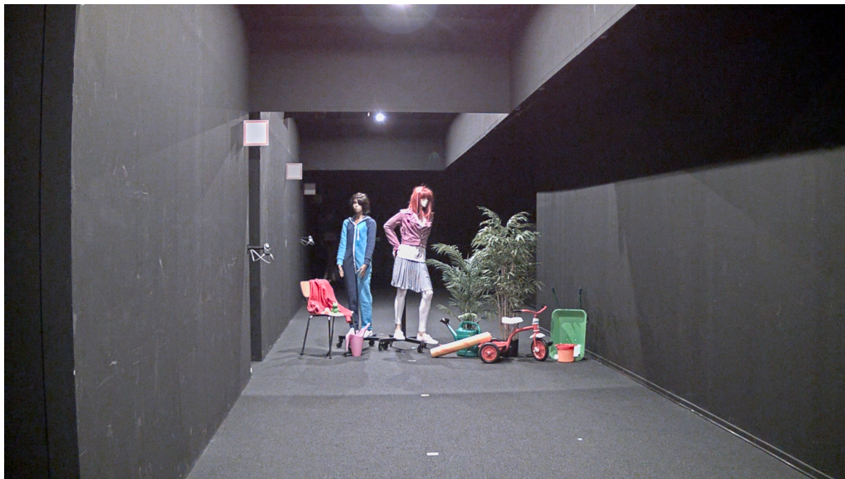
Figure 4. Eine Studioszene mit einer Lichtstärke zwischen 1,5 Lux (am Dreirad) und 5 Lux (in Höhe der Puppentaille). Die Lightfinder-Kamera lieferte klarere Farben und ein scheinbar helles Bild. Das menschliche Auge konnte die Farben ebenfalls unterscheiden, nahm die Szene aber als sehr dunkel wahr.
