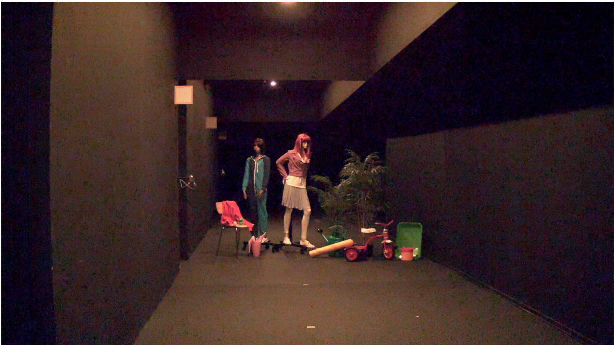
Figure 6. 0,1 Lux – 0,3 Lux an den Objekten gemessen. Die Lightfinder-Kamera liefert ein weniger scharfes, aber immer noch sehr detailliertes Farbbild. Das menschliche Auge konnte die dunkleren Flächen nicht erkennen und nahm keine Details oder Farben wahr.
