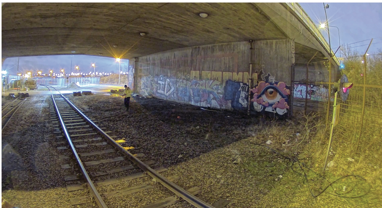
Figure 9. Ein scharfes, helles Farbbild von einer Kamera mit Lightfinder 2.0, obwohl die Lichtstärke unter der Brücke nur 0,05 Lux betrug.
