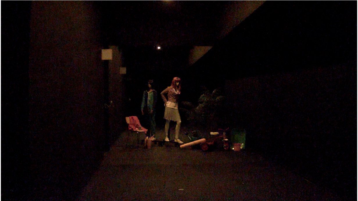
Figure 7. 0,02 Lux – 0,08 Lux an den Objekten gemessen. Die Kamera mit Lightfinder liefert ein dunkles Bild mit gedämpften, aber erkennbaren Farben. Das menschliche Auge konnte die hellsten Flächen nur vage erkennen und nahm keinerlei Details oder Farben wahr.
