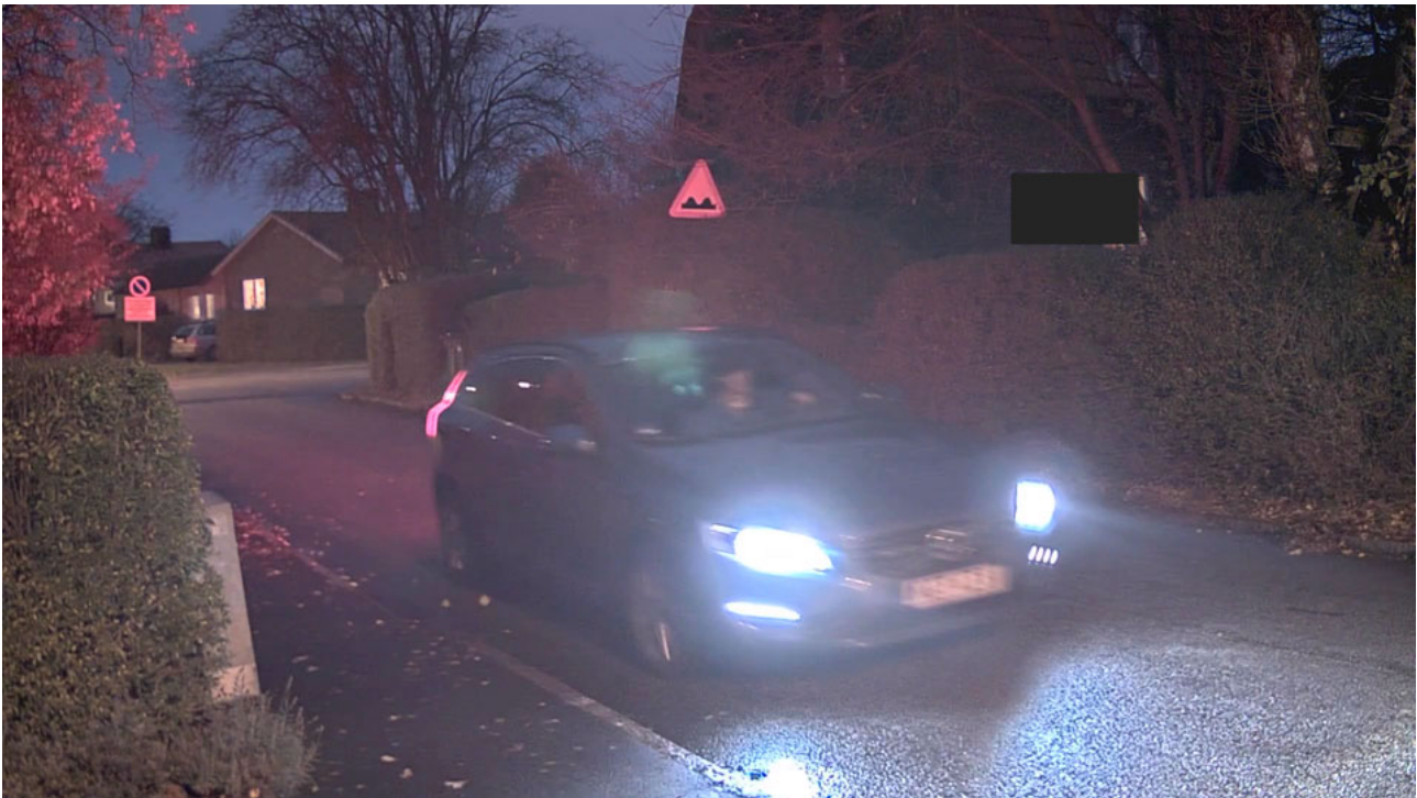
Lange Belichtungszeit kann sichtbare Bewegungsunschärfe hervorrufen. Bei diesem Schnappschuss wäre das Fahrzeugkennzeichen bei einer kürzeren Belichtungszeit möglicherweise lesbar gewesen.
