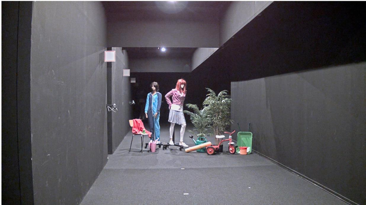
*Figure 4. Escena de estudio con una intensidad de la luz de entre 1,5 lux (en el triciclo) y 5 lux (a la altura de la cintura de los maniquíes). La cámara Lightfinder generó una imagen con unos colores claros y un brillo engañoso. El ojo humano también era capaz de distinguir el color, pero la percepción era de una escena muy oscura.*
