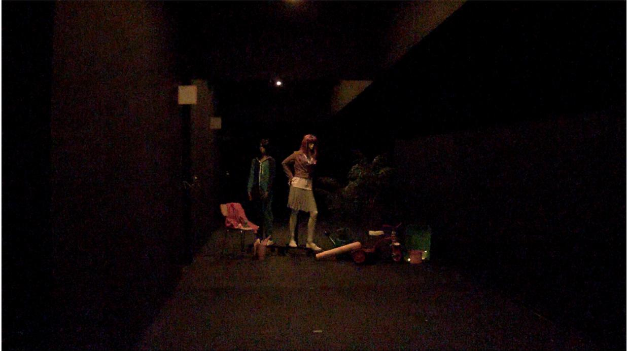
*Figure 7. 0,02 lux-0,08 lux medidos en los objetos. La cámara Lightfinder obtiene una imagen oscura, con colores menos intensos pero distinguibles. El ojo humano solo podía distinguir vagamente las superficies más claras, sin poder percibir detalles ni colores de ningún tipo.*
