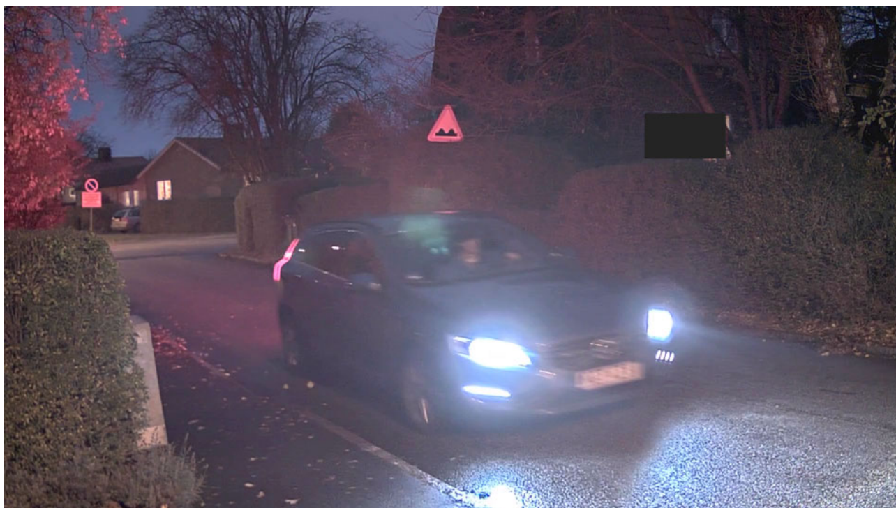
Un tiempo de exposición prolongado puede provocar una distorsión por movimiento visible. En esta instantánea, la matrícula podría haber sido legible con un tiempo de exposición más breve.
