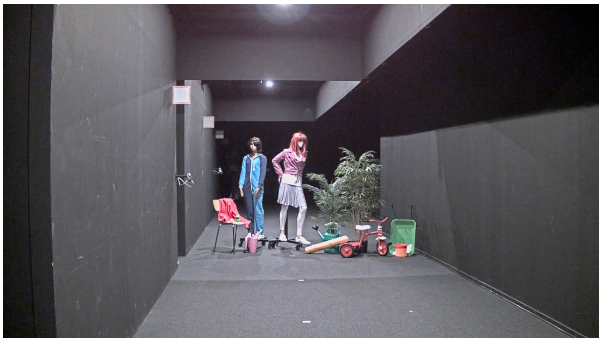
Figure 4. Scène de studio où l'intensité lumineuse est comprise entre 1,5 lux (sur le tricycle) et 5 lux (à hauteur de la ceinture des mannequins). La caméra Lightfinder restitue des couleurs marquées et une image étonnamment claire. L'œil humain peut également discerner des couleurs, mais perçoit une scène très sombre.
