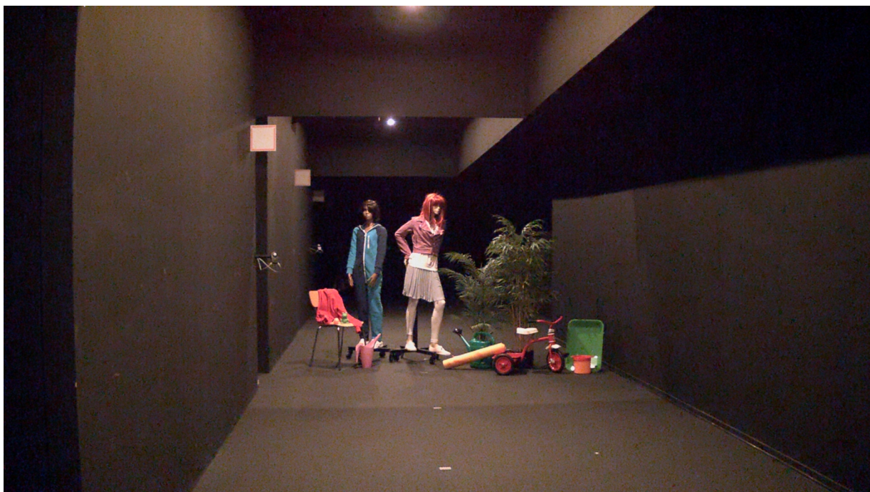
Figure 5. 0,2 lux – 0,7 lux mesuré sur les objets. La caméra Lightfinder restitue des couleurs vives. Pour l'œil humain, la vision des couleurs est discutable et seules les surfaces claires sont perceptibles, avec perte prononcée de détails.
