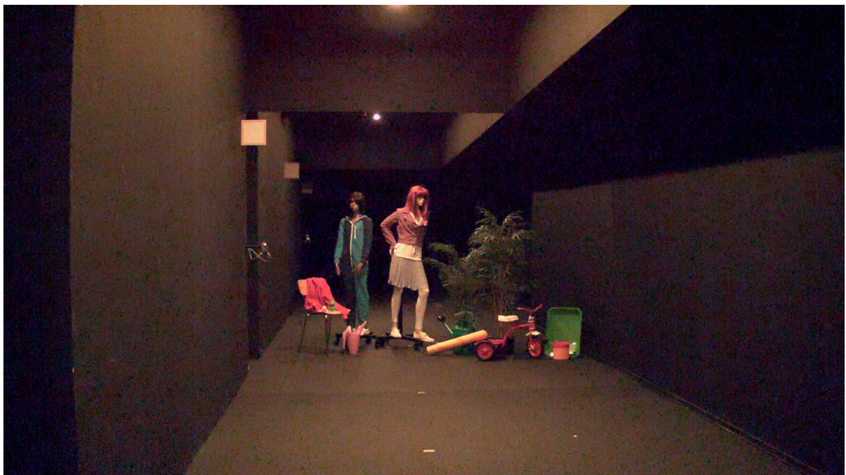
Figure 6. 0,1 lux – 0,3 lux misurati sugli oggetti. La telecamera con Lightfinder offre un'immagine meno nitida, ma molto dettagliata e a colori. L'occhio non riesce a distinguere le superfici più scure e non percepisce i dettagli e i colori.
