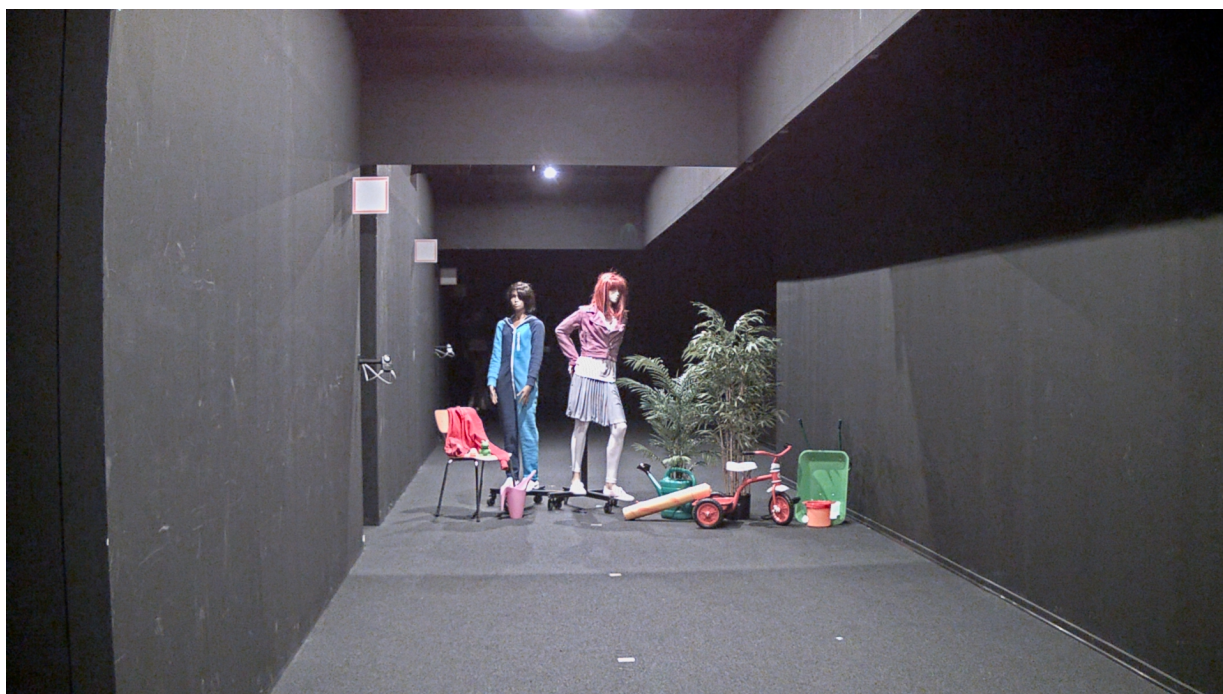
Figure 4. Scena in studio con un'intensità luminosa tra 1,5 lux (triciclo) e 5 lux (alla vita del manichino). La telecamera con Lightfinder offre colori nitidi e un'immagine apparentemente chiara. Anche l'occhio è in grado di distinguere i colori, ma percepisce un'immagine molto scura.
