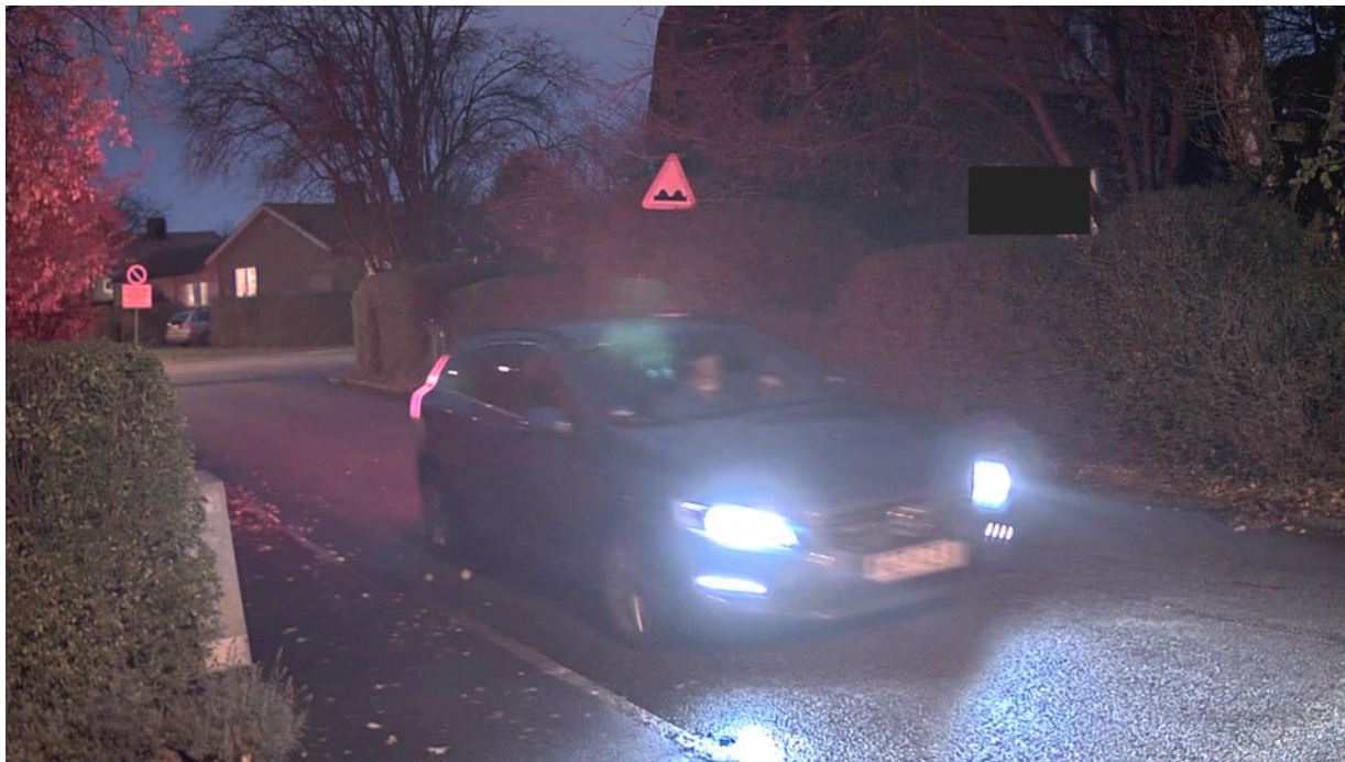
Figure 8. Un tempo di esposizione lungo può causare una sfocatura da movimento visibile. In questa istantanea, la targa sarebbe stata leggibile con un tempo di esposizione breve.
