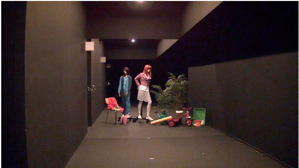
Figure 5. 0,2 lux – 0,7 lux misurati sugli oggetti. La telecamera Lightfinder riproduce colori brillanti. L'occhio ha una visione dei colori ambigua e può distinguere principalmente le superfici chiare, con pochi dettagli.
