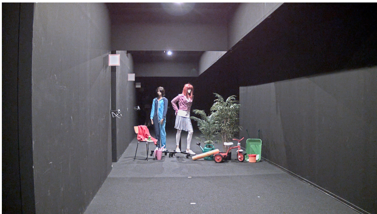
Figure 4. Scena w studio z oświetleniem o natężeniu od 1,5 luksa (na rowerku) do 5 luksów (na wysokości talii manekinów). Kamera z technologią Lightfinder zapewnia wyraźne kolory i ładząco jasny obraz. Oko ludzkie również jest w stanie rozróżnić kolory, ale odbiera tę scenę jako bardzo ciemną.
