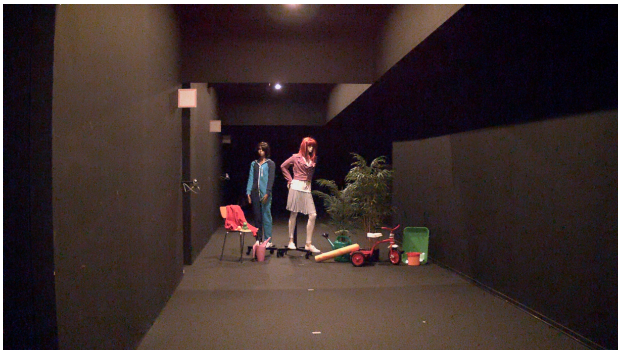
Figure 5. Oświetlenie o natężeniu 0,2–0,7 luksa zmierzone na obiektach. Kamera z technologią Lightfinder zapewnia wyraźne kolory. Ludzkie oko nie rozróżnia wyraźnie kolorów: dostrzegane są jasne powierzchnie i naprawdę niewielka ilość szczegółów.
