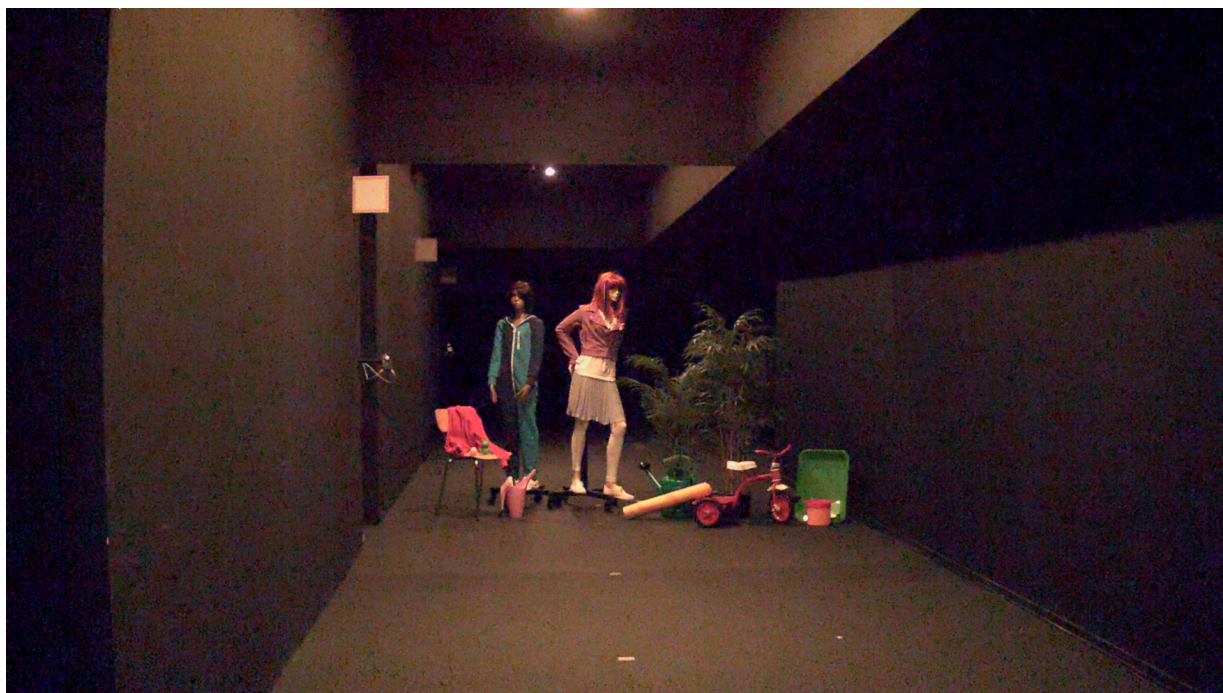
Figure 6. Oświetlenie o natężeniu 0,1–0,3 luksa zmierzone na obiektach. Kamera z technologią Lightfinder przekazuje mniej ostry, ale wciąż bardzo szczegółowy i kolorowy obraz. Oko ludzkie nie jest w stanie rozróżnić ciemniejszych powierzchni i nie dostrzega szczegółów ani kolorów.
