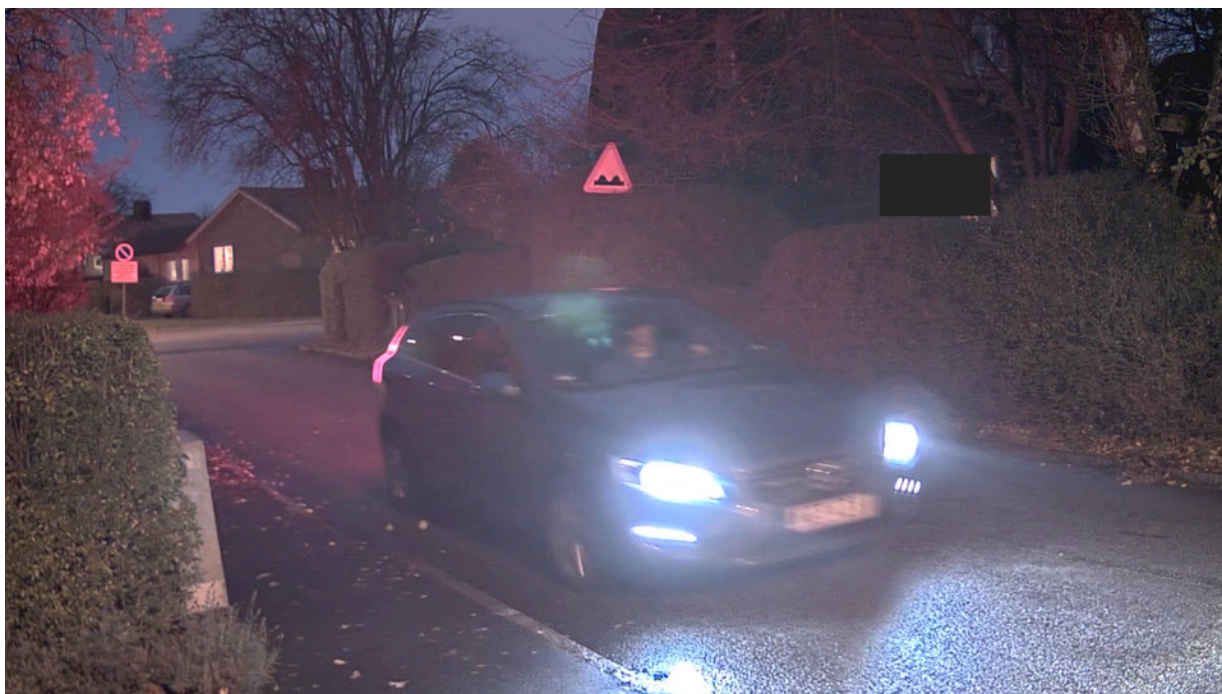
Figure 8. 长曝光时间可能导致明显的运动模糊。在此视频抓拍中，如果缩短所使用的曝光时间，车牌可能更易于辨认。
