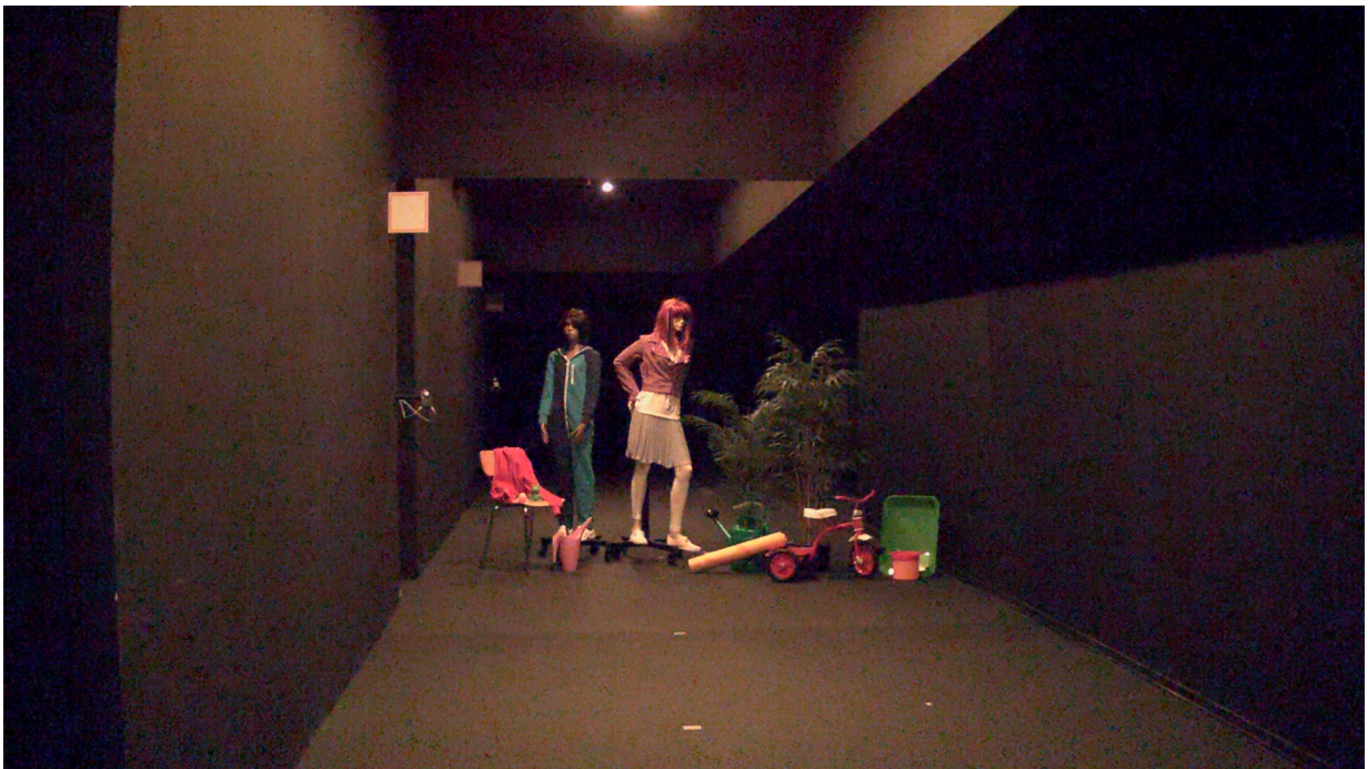
Figure 6. 目标上测得的照度为0.1–0.3 lux。“觅光者”摄像机提供的彩色图像清晰度有所下降，但细节仍然非常丰富。人眼无法辨认较暗表面，无法感知细节或色彩。
