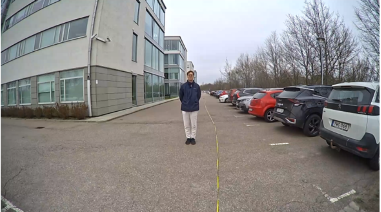
Figure 3.2 Sur le lieu de l'enregistrement, la distance maximale d'enregistrement est de 4 m par rapport à une caméra-piéton Axis.
