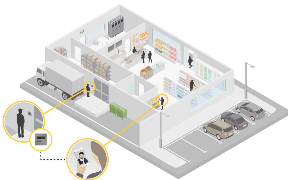
Figure 2. Installation de sécurité typique d'une petite ou moyenne entreprise. Le visiophone permet au personnel de réceptionner des marchandises et d'ouvrir la porte aux visiteurs sans laisser les clients seuls.
