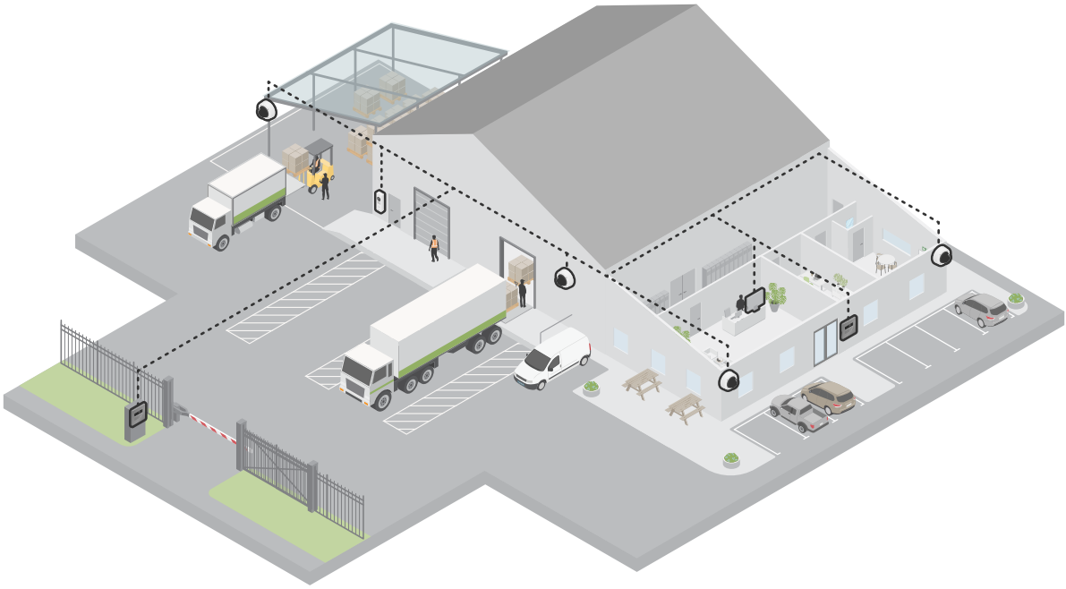
Figure 3. 在大型系统（例如在物流中心或机场）中，视频对讲机是网络监控摄像机、门禁控制系统、入侵报警及其他安防应用的集成解决方案的有益补充。
