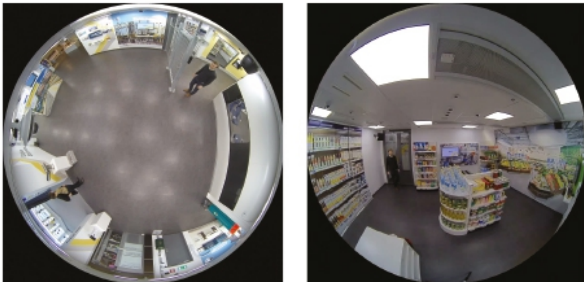
Kreisrunde Ansichten von Einzelsensorkameras. Eine deckenmontierte Kamera bietet einen kompletten Überblick über den gesamten Raum (links). Eine wandmontierte Kamera bietet einen Überblick in einem Winkel, der geeignet ist, Gesichter zu sehen (rechts).
