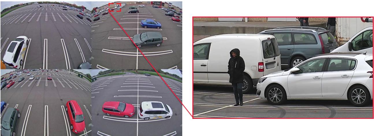
*Überwachung eines Parkplatzes mit einer multidirektionalen Kamera mit PTZ.*
