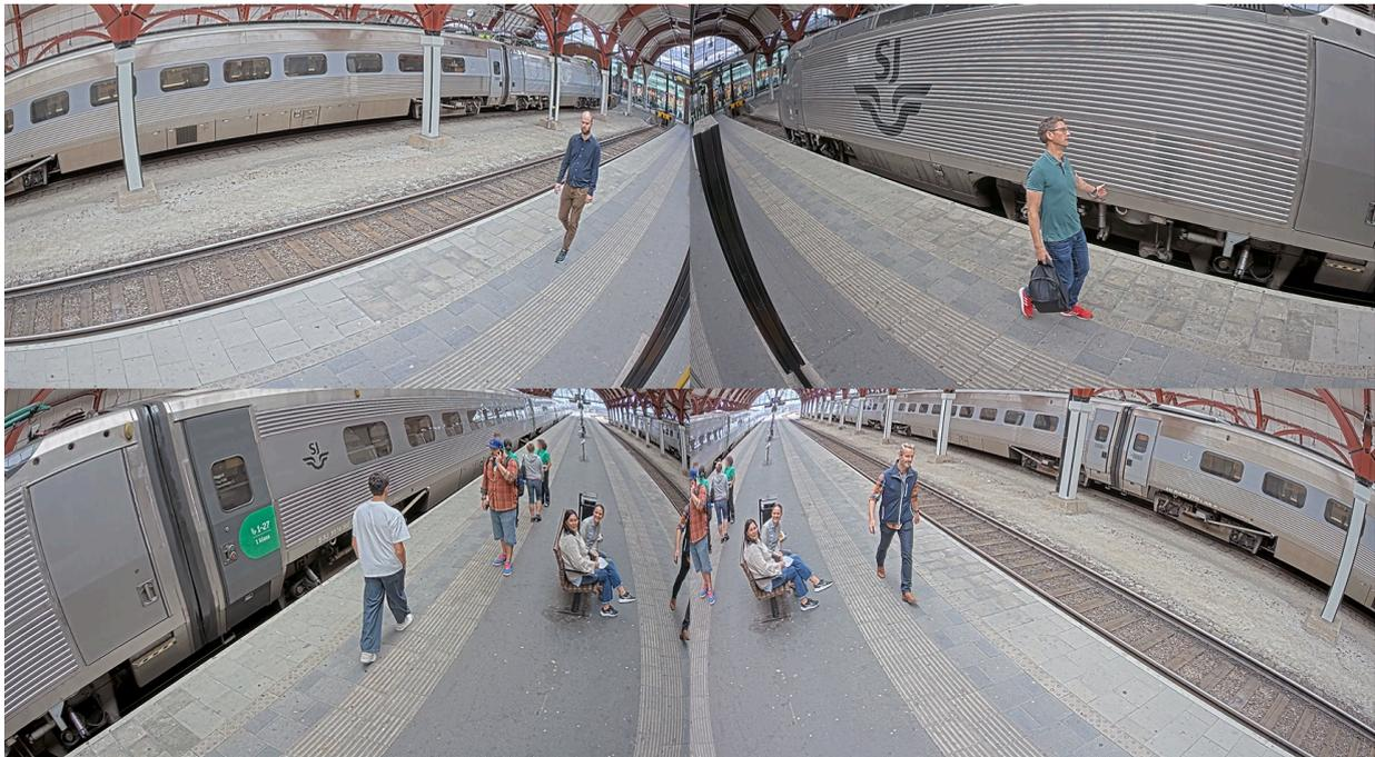
*Die vier Ansichten einer Mehrrichtungskamera an einem Bahnhof. In diesem Beispiel liefern zwei der Varifokalobjektive vergrößerte Ansichten.*
