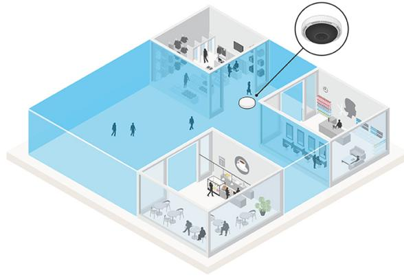
*Eine Mehrrichtungskamera bei Optimierung zur Installation an einer äußeren Ecke. Drei Sensoren bieten die erforderliche 270°-Abdeckung, und der vierte Sensor kann nach unten gerichtet werden und für bessere Auflösung den Bereich direkt unterhalb der Kamera vergrößern.*
