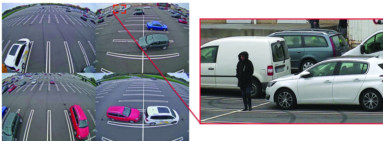
Vigilancia de aparcamiento utilizando una cámara multidireccional con PTZ. Vista cuádruple de 360° y vista ampliada con PTZ.
