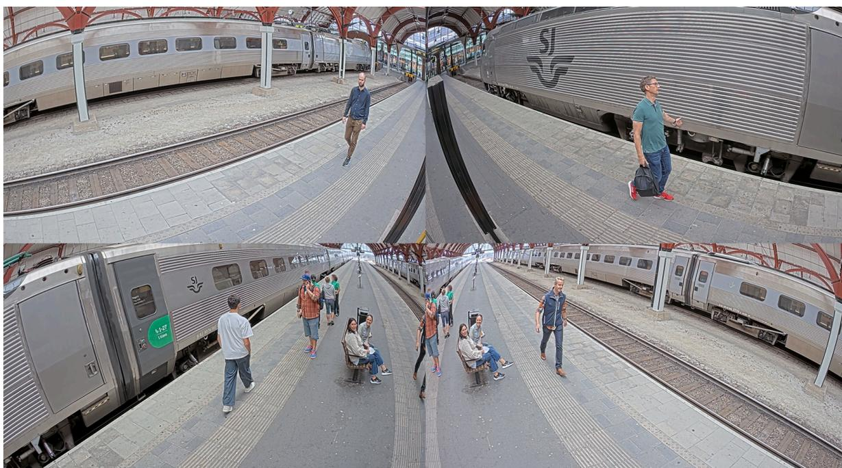
*Las cuatro vistas de una cámara multidireccional instalada en una estación de tren. En este ejemplo, dos de los objetivos varifocales proporcionan vistas ampliadas.*
