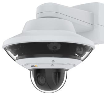
Una cámara multidireccional con PTZ es la suma de una cámara multidireccional de 360° y una cámara PTZ motorizada, montadas como una sola unidad. La cámara multidireccional ofrece una visión general completa y la cámara PTZ ofrece unos primeros planos detallados y nítidos con un alto valor forense, todo ello controlado y con suministro de corriente a través de un cable de red.
