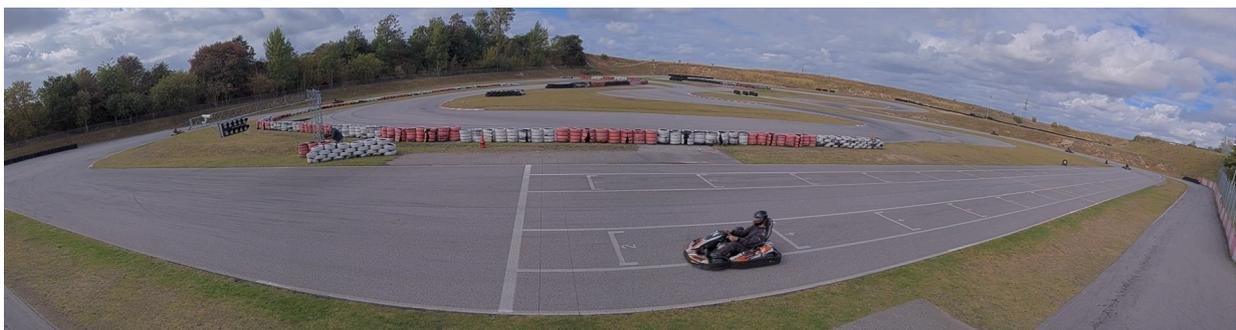
*Un FoV vertical inferior a menudo proporciona la cobertura necesaria, con una densidad de píxel superior.*
