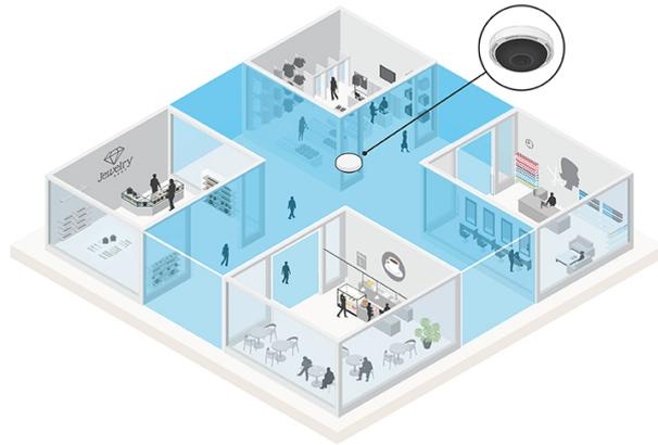
*Una cámara multidireccional con sus sensores móviles ubicados en posición equidistante proporciona una vista de conjunto completa en situaciones como una intersección de pasillos.*
