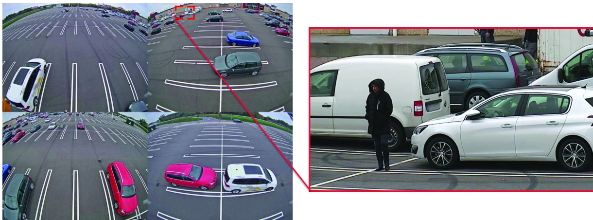
Surveillance d'un parking à l'aide d'une caméra multidirectionnelle avec dôme PTZ. Vue quadrivision à 360° et vue zoomée PTZ.
