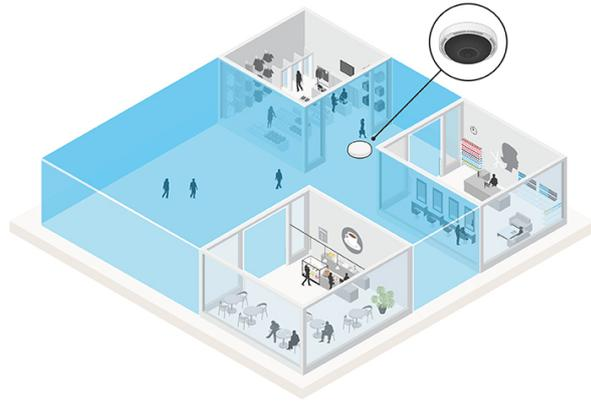
*Une caméra multidirectionnelle lorsqu'elle est optimisée pour une installation sur un angle extérieur. Trois capteurs assurent la couverture de 270° nécessaire, et le quatrième capteur peut être dirigé vers le bas et zoomé pour une meilleure résolution juste en dessous de la caméra.*
