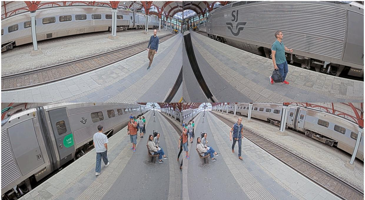
*Les quatre vues d'une caméra multidirectionnelle placée dans une gare. Dans cet exemple, deux des objectifs à focale variable fournissent des vues zoomées.*
