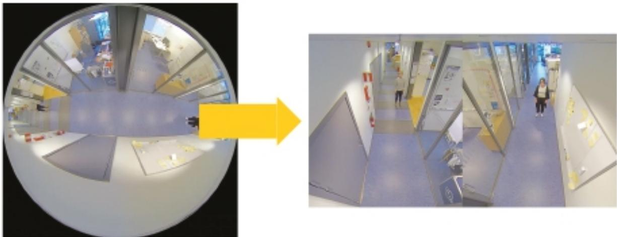
*Ao reduzir a distorção e escolher o formato corredor, uma visão geral circular de um corredor (à esquerda) pode ser transformada em duas imagens úteis (à direita).*
