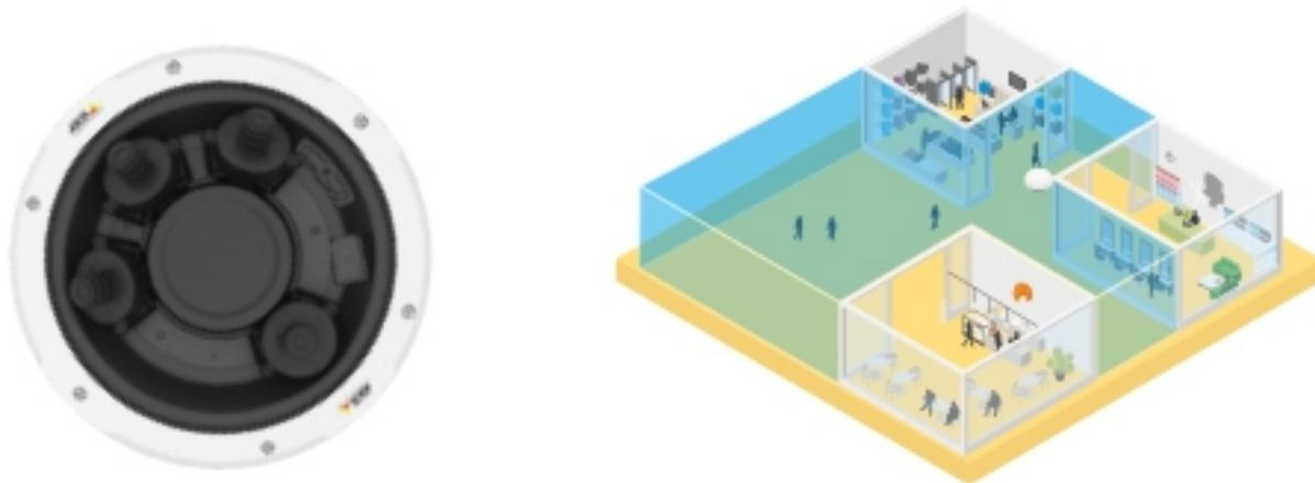
*Uma câmera multidirecional quando otimizada para instalação em um canto externo. Três sensores fornecem a cobertura necessária de 270°, e o quarto sensor pode ser direcionado para baixo e aumentar o zoom para obter melhor resolução logo abaixo da câmera.*
