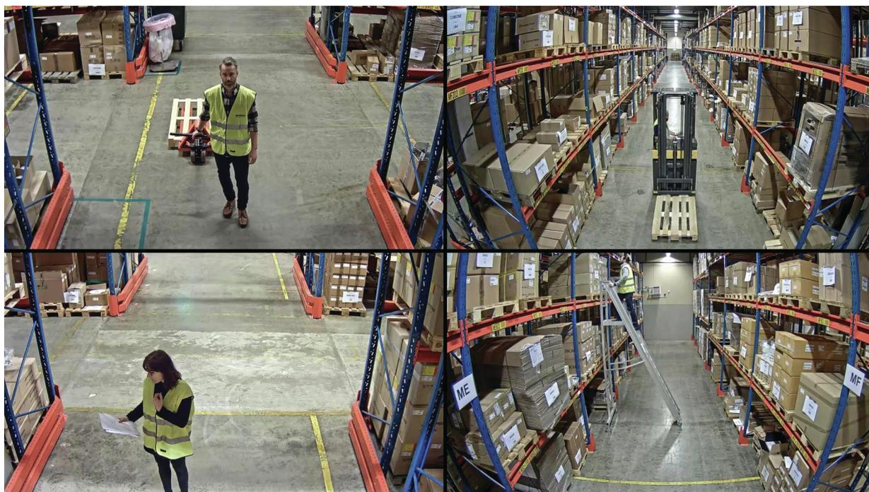
*As quatro visualizações de uma câmera multidirecional colocada na interseção de um armazém. Neste exemplo, duas das lentes varifocais oferecem visões ampliadas.*
