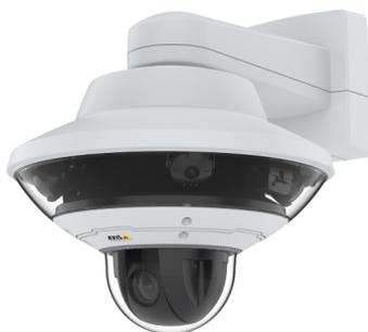
Uma câmera multidirecional com PTZ é uma combinação de uma câmera multidirecional de 360° e uma câmera PTZ motorizada, montada como uma unidade. A câmera multidirecional oferece uma visão geral completa e uma câmera PTZ oferece vídeos em close-up nítidos e detalhados com alto valor forense, todas alimentadas e controladas através de um cabo de rede.
