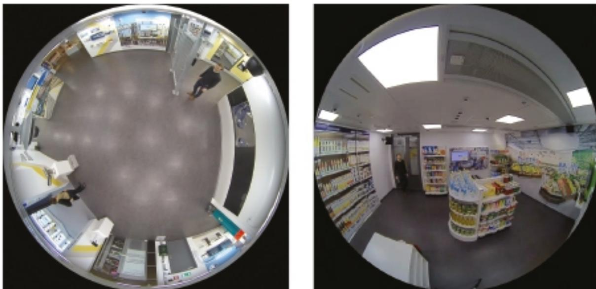
*Visões circulares de câmeras de sensor simples. Uma câmera montada no teto oferece uma visão geral completa de toda a sala (à esquerda). Uma câmera montada na parede oferece uma visão geral em um ângulo adequado para ver os rostos das pessoas (à direita).*
