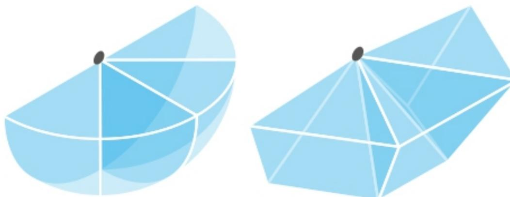
*Campos de visão de câmeras multissensor montadas na parede. Esquerda: Uma câmera com quatro sensores fornece um campo de visão horizontal de 180° e vertical de 90°. Direita: Uma câmera com três sensores fornece um campo de visão horizontal de 180° e vertical de 60°.*
