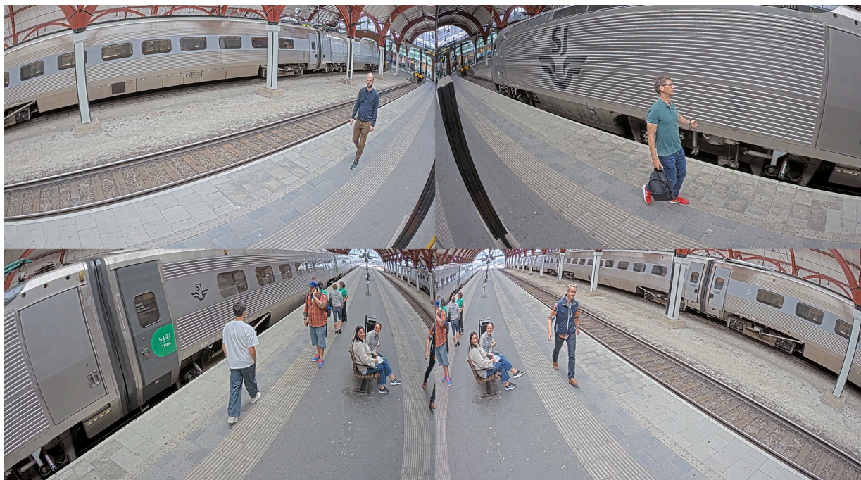
As quatro visualizações de uma câmera multidirecional colocada em uma estação de trem. Neste exemplo, duas das lentes varifocais oferecem visões ampliadas.
