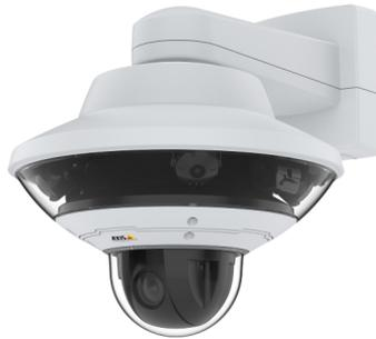
配備PTZ的多指向攝影機在同一個裝置內，結合一台多向360°攝影機和一台馬達驅動的PTZ攝影機。多指向攝影機提供完整概觀，而PTZ攝影機提供具有高鑑識價值的銳利詳細特寫影像，這些全部可由一條網路線供電和控制。
