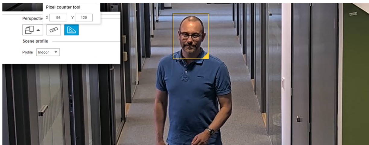
Figure 4. Champ de la caméra où le compteur de pixels est visible. L'outil indique qu'il y a 96 pixels dans l'image, ce qui signifie que l'identification est possible (il faut au moins 40 pixels sur le visage).
